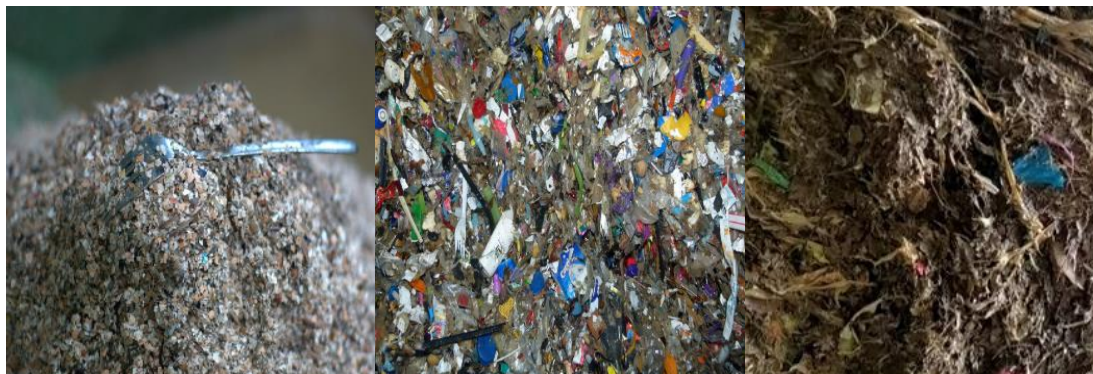
Ryc. 16. Frakcja sitowa oraz frakcja lekka z hydromechanicznego oczyszczania
